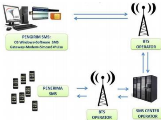
Gambar 2. Mekanisme Kerja SMS Gateway (Sumber : http://smsgatewaymurah.com/ )
